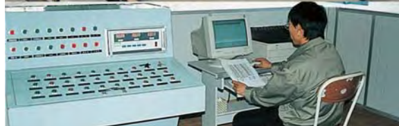
▲ 2000m 3 /h泵全性能测试台
