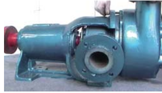
30. 用螺栓连接, 注意: 此时无需将螺栓拧紧
