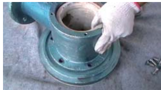
2. 在后泵盖上安装吸入口三通接管
