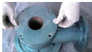
12. 安装密封盒压盖（内侧有台阶端朝下）
