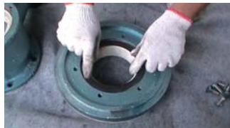
1. 在后泵盖上放置吸入口三通垫床
