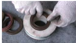
4. 在密封盒中装入第一只K形密封圈（唇口向下）
