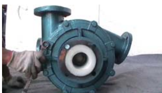
45. 用螺栓与泵壳连接, 并对角均匀拧紧 ※注③
