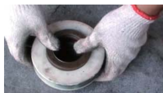
8. 装入第三只K形密封圈（唇口向下）
