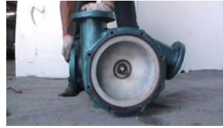
31. 将吸入口三通接管调节至水平位置
