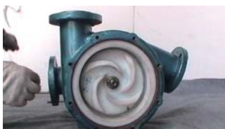
37. 逆时针方向旋上防转螺母
