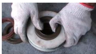
5. 装入第二只K形密封圈（唇口向下）
