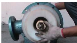
22. 套入前轴套（台阶深的一端朝外）
