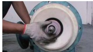
20. 套入减压副叶轮（有叶片的一面朝内）
