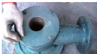
13. 用螺栓将其连接，注意：此时无需将螺栓拧紧！
