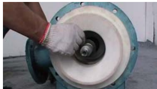
19. 在主轴前端套入减压副叶轮垫
