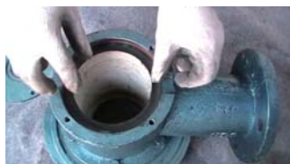
10. 在吸入口三通接管上放置密封盒垫
