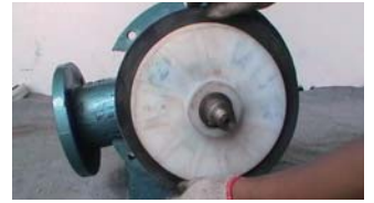
28. 在后泵盖上套入后泵盖垫
