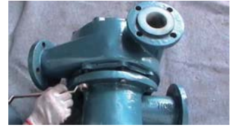
32. 对角均匀拧紧泵壳与轴承座的连接螺栓
