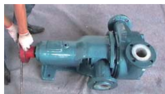
38. 固定联轴器, 防止主轴转动
