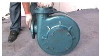
39. 将吸入口三通接管调节至水平位置
