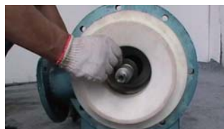
16. 在主轴前端套入减压副叶轮垫
