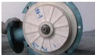
25. 逆时针方向旋上防转螺母
