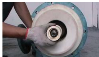
19. 套入前轴套（台阶深的一端朝外）
