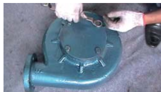
35. 用螺栓与泵壳连接，并对角均匀拧紧
