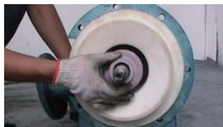
17. 套入减压副叶轮（有叶片的一面朝内）
