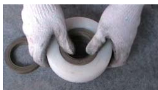
5. 装入第二只K形密封圈（唇口向下）
