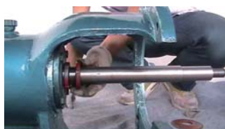
11. 在主轴上依次旋上两只主轴拼帽（至螺纹露出）
