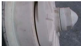
31. 检查叶轮与后泵盖之间的间隙 ※注①
