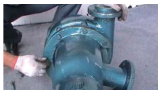
38. 用螺栓连接，注意：此时无需将螺栓拧紧！
