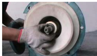
20. 套入叶轮顶圈
