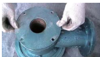
9. 安装密封盒压盖（内侧有台阶端朝下）
