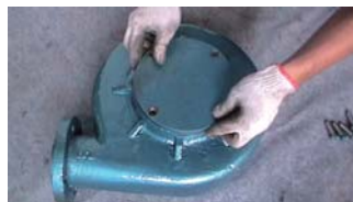
34. 装上闷盖压板
