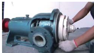
36. 在后泵盖上套入后泵盖垫
