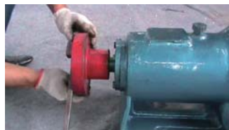
26. 固定联轴器，防止主轴转动
